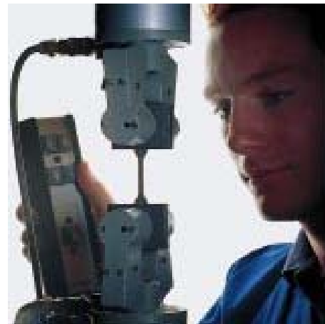
испытания на удлинение и сцепления с помощью электродинамометра
