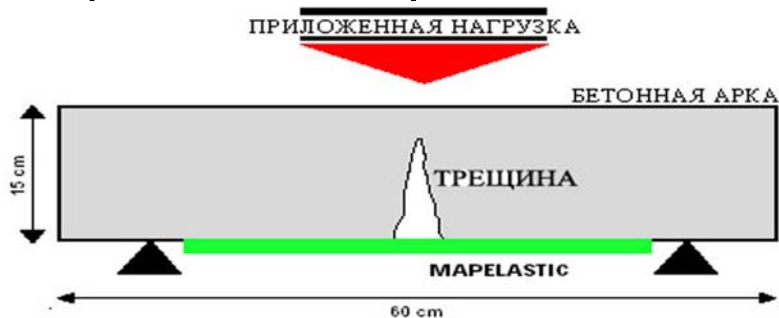
Рис. 1 защита волосяной трещины бетонной арки, подчиненной нагрузке на изгиб
