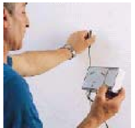
Проверка влажности штукатурки
